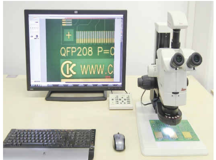
Mit einem Mikroskop von Leica werden Pad- und Öffnungsgrößen vermessen
