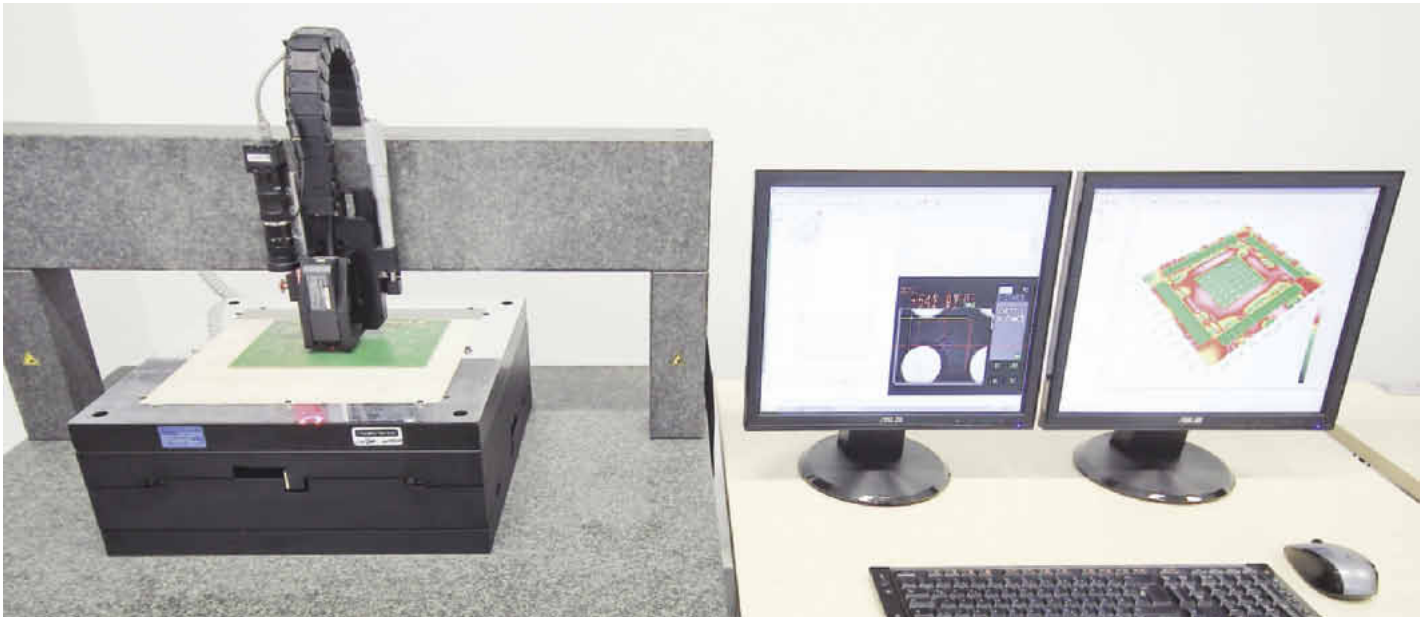
Das CT 300 ist ideal für die Messung der Ebenheit mit hoher Genauigkeit über den gesamten Verfahrensweg von (300x300)mm 2
