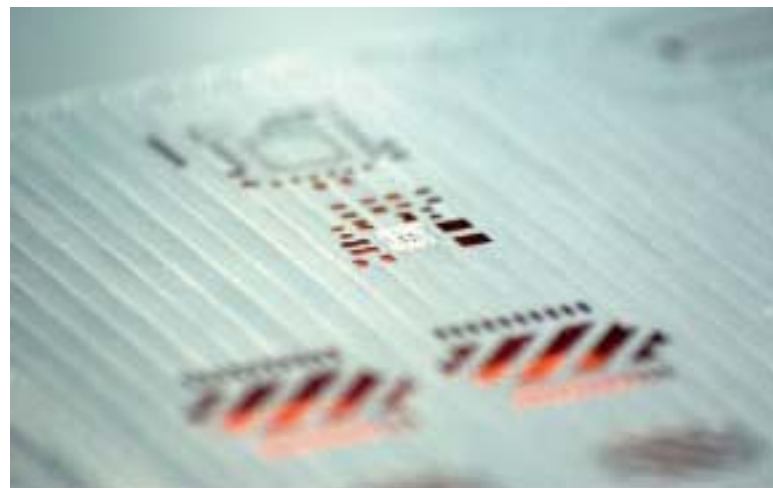
Stufe für CSP-Bauteil auf 100µm Schablonendicke
