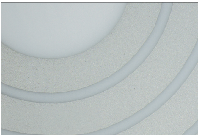
800 µm ANTENNENSTRUKTUR gedruckt mit M-TeCK; Höhe: 60 µm
